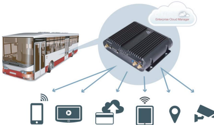
Ce routeur professionnel établit une connexion Internet mobile via un opérateur de réseau mobile et la partage un réseau Wifi et Ethernet
